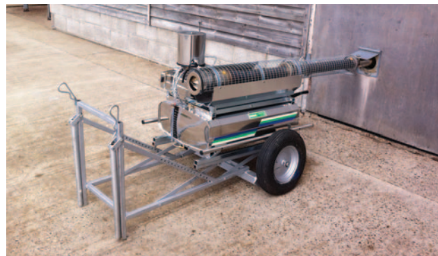
Illustration 3. Brumisateur thermique (photo de Agrex Limited)
